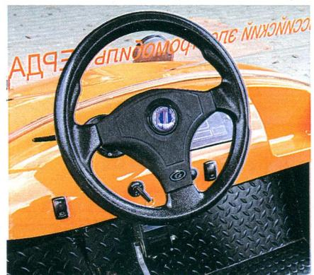
В органах управления не запутаешься. Справа от руля – замок «зажигания» и кнопка «вперед-назад». Слева – включатель указателей поворотов и клавиша освещения.
