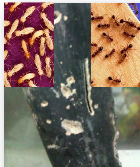
Рисунок 2 Повреждения термитами кабеля с обычной оболочкой (не защищенной от муравьев и термитов)
