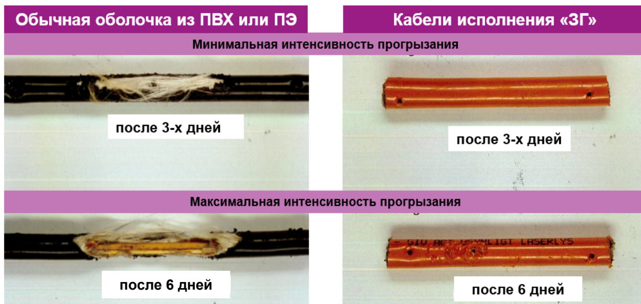
Рисунок 1 Сравнение кабелей по стойкости к грызунам. Испытания проводились в лаборатории Justus Liebig University Giessen (Германия)
