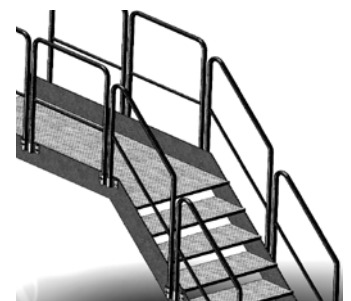
Рис. 1.4 Ограждение с уклоном
